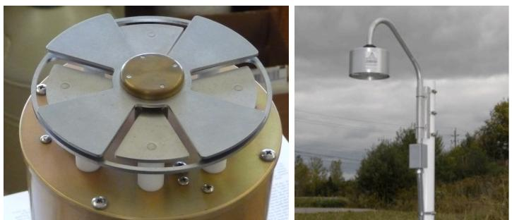
Ukázka konstrukce měřící elektrody (vlevo) a aktuálního umístění přístroje v terénu (vpravo). Princip přístroje spočívá v tom, že rotující uzemněná clonka střídavě zakrývá a odkrývá měřící elektrodu, čímž donutí neznámý, na ní indukovaný náboj k pohybu přes měřící elektroniku.
