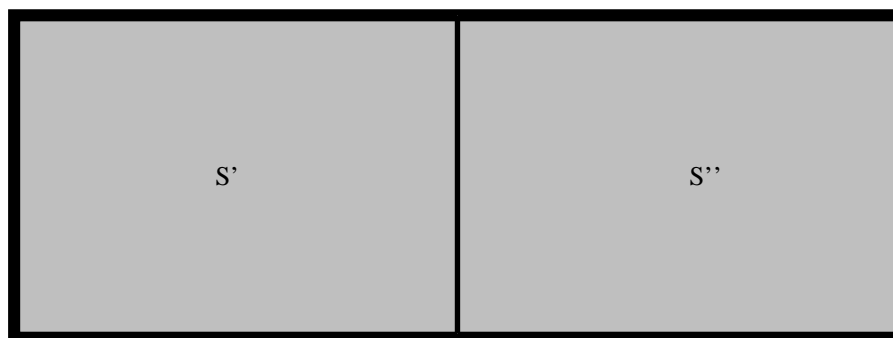
Obrázek 6.2: Nádoba s plynem rozdělená přepážkou na dvě stejné části. Entropie plynu v levé části je S' entropie plynu v pravé části je S'' .
