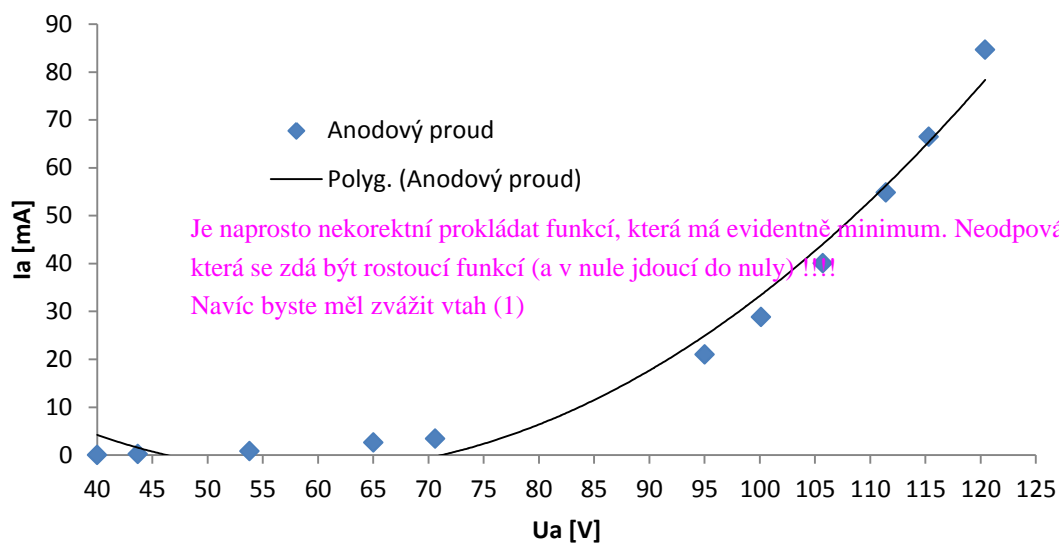
Graph 2: Anodová charakteristika triódy pro napětí U_g = -1,5V
