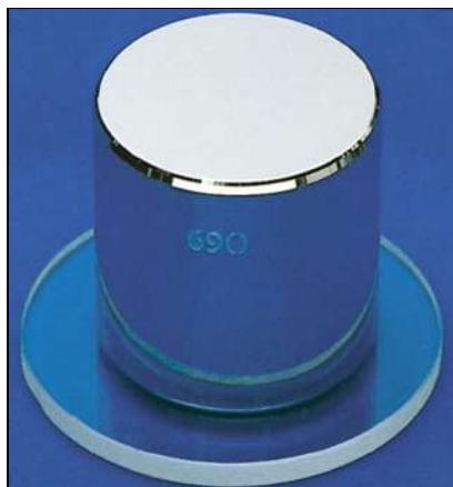
Obr. 1.6 Mezinárodní hmotnostní standard 1 kg má tvar válce, jehož výška i průměr jsou 39 mm.
