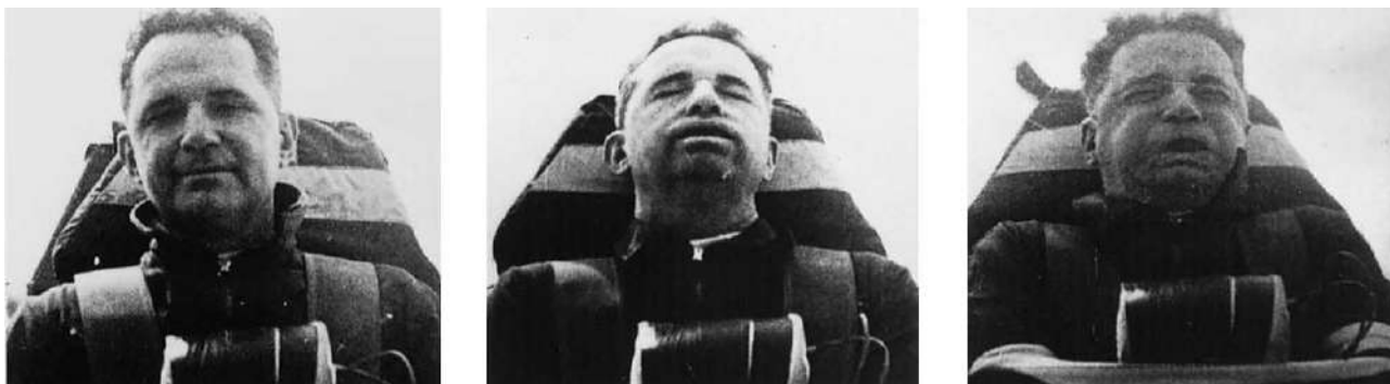
Obř. 2.8 Plukovník J. P. Stapp v raketových saních při urychlování na vysokou rychlost (zrychlení směřuje ke čtenáři) a při brzdění (zrychlení směřuje od čtenáře).
