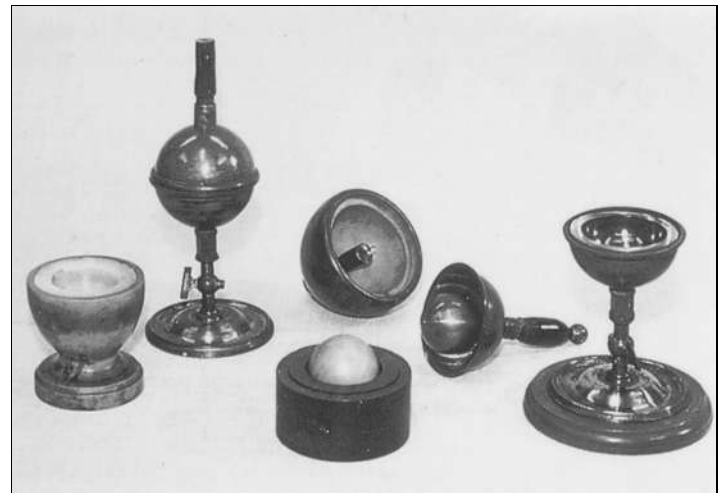
Obr. 26.11 Jednoduché elektrostatické přístroje používané Faradayem. Složený přístroj (druhý zleva) se skládá z vnitřní mosazné koule a z vnější soustředné mosazné kulové vrstvy. Do prostoru mezi kouli a kulovou vrstvou vložil Faraday vrstvu dielektrika.
